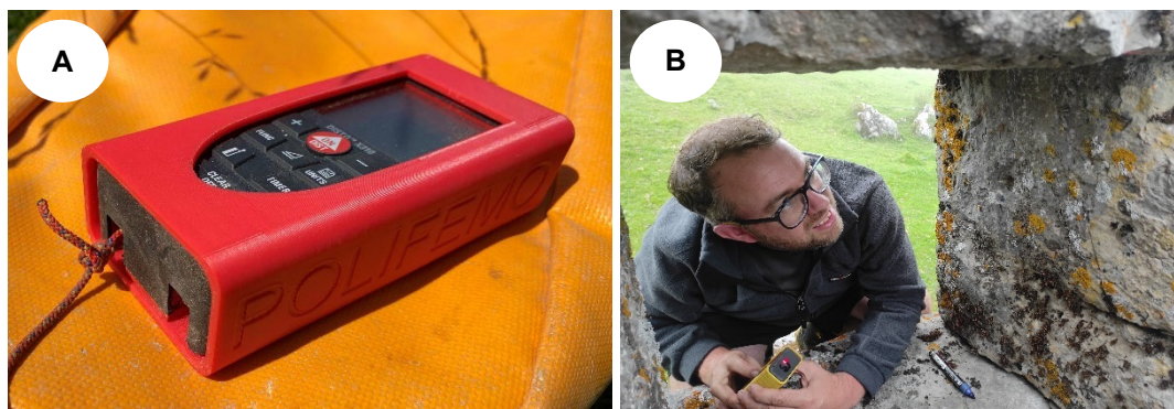
Figura 2. A Distanciómetro láser DistoX2 protegido por una funda diseñada mediante una impresora 3D. B Tareas de calibración del DistoX2 en el propio campamento.
